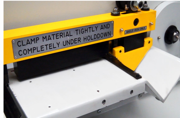
Pisadores automáticos de uretano para todas las estaciones de corte (barra, solera y ángulo)
