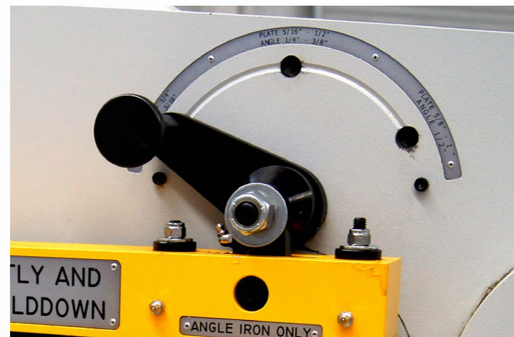
Seleccionador de espesores para estaciones de corte
