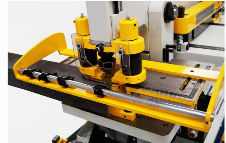
Mesa de reposicionado rápido con topes abatibles (escantillones) para punzonar agujeros múltiples en ángulo
