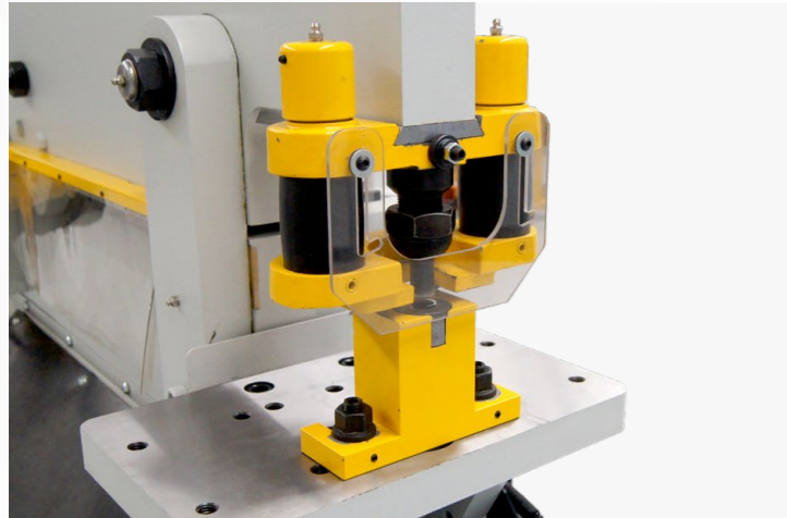
Herramental para punzonado con botadores de uretano
